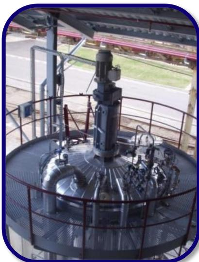
Ils peuvent être livrés fabriqués de différents matériaux, le matériau CS, SS + par exemple le gommage, éventuellement un traitement de surface différent dans le but d'assurer la résistance au médium utilisée
